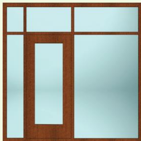
Gewijzigde kozijnindeling waarbij de karakteristieke middendorpel is verwijderd. Dit is een voorbeeld van een wijziging van de kozijnindeling die niet is toegestaan.
